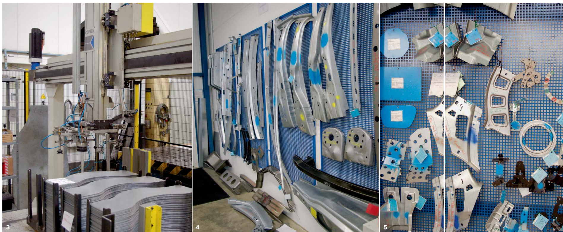
3 _ Die Copren-Platinenzuführanlage mit »Linearmotortechnik« versorgt die beiden Drei-Achs-Transfereinheiten an der Presse. 4 und 5 _ Flexibilität bedeutet für PM Automotive alles. Das Teilespektrum verdeutlicht dies.
